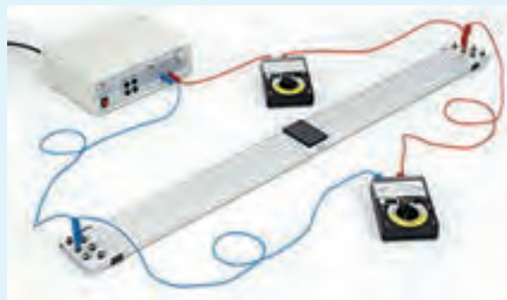
الف) اسباب آزمایش اندازه‌گیری مقاومت یک سیم رسانا
