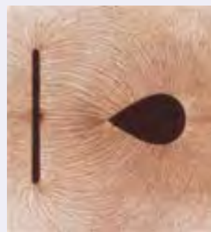
(الف) اسباب آزمایش فعالیت ۳-۱ به طوری که در آن الکترودها با یک صفحه تخت رسانا و یک رسانای دوکی شکل جایگزین شده‌اند. میدان الکتریکی در نقاط تیزتر جسم دوکی شکل قوی‌تر است.
