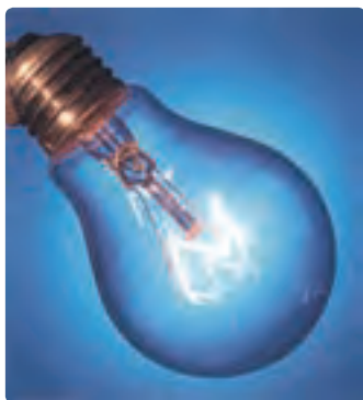
شکل ۲-۱۳ عبور جریان از رشته (فیلامان) تنگستنی موجب درخشش لامپ جبابی شده است.
