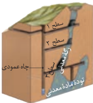
شکل ۸-۲: نحوه بهره برداری از معادن زیرزمینی
