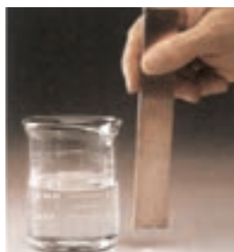
● تیغه مس درون محلول روی سولفات پس از مدت طولانی.
