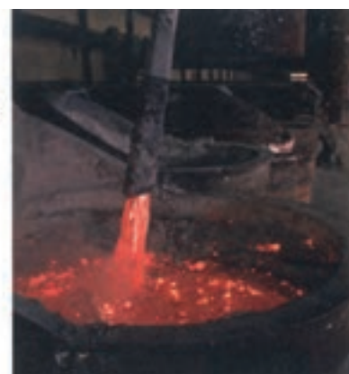
شکل ۱۸- فرایند هال برای تولید آلومینیم از \text{Al}_2\text{O}_3
