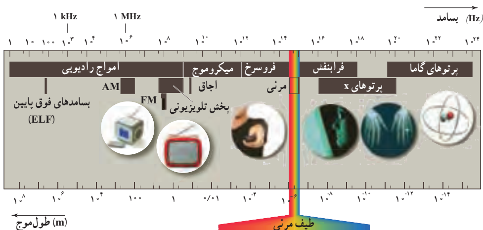
شکل ۳-۲۲ طیف امواج الکترومغناطیسی
