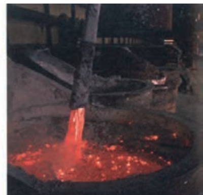
شکل ۱۸- فرایند هال برای تولید آلومینیم از \text{Al}_2\text{O}_3
