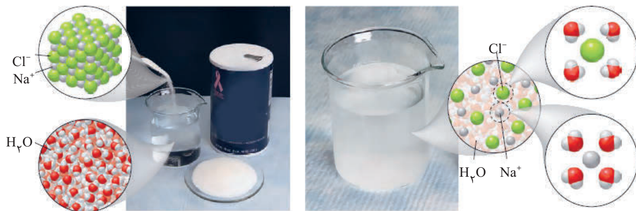
شکل ۲۲- فرایند انحلال سدیم کلرید در آب و تشکیل یون‌های آبپوشیده
