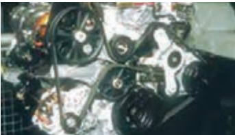
تسمه پروانه در موتور اتومبیل چرخ‌هایی با اندازه‌های متفاوت را به هم متصل می‌کند.
