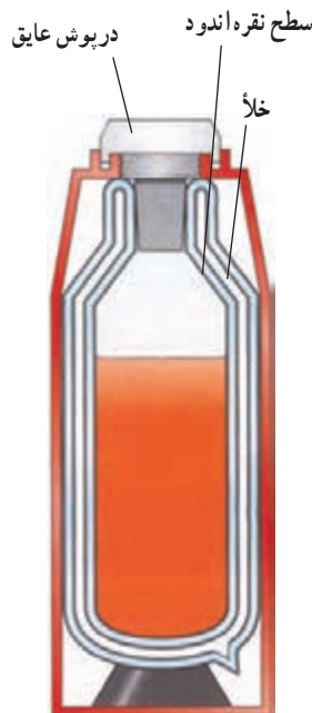
شکل ۱۳. دما بان خلأ می‌تواند مدت نسبتاً زیادی دمای جسم را تقریباً ثابت نگه دارد.
