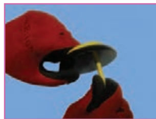
پ - اتصال محور به یکی از چرخ‌ها
