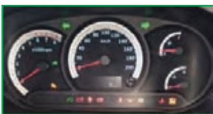
شکل ۹-۱۴- چراغ‌های هشداردهنده خودرو
