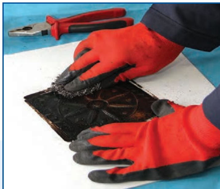
شکل ۱۱-۱۱- ساب زدن سطح پلاک مسی
