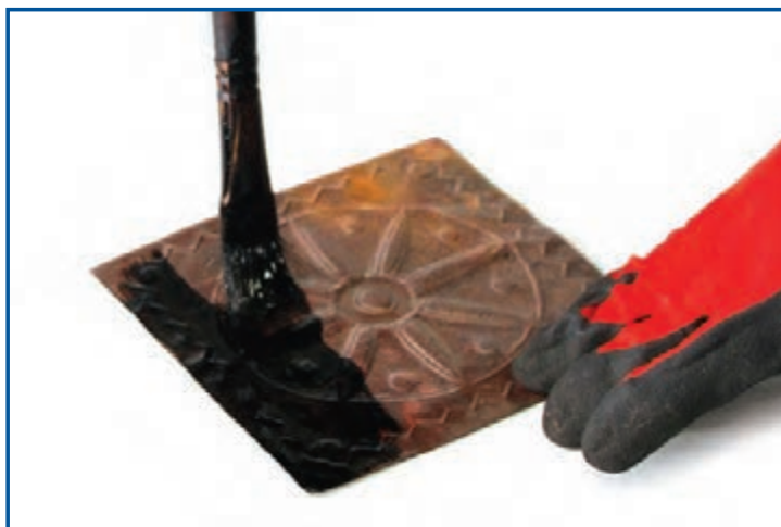
شکل ۱۰-۱۱- آغشته کردن سطح پلاک مسی به قیر
