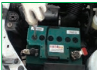
ج - در خانه‌های باتری را ببندید و سطح باتری را مجدداً تمیز کنید.
