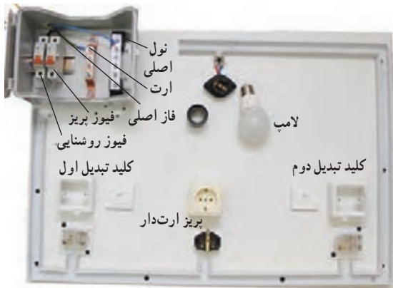
شکل ۲۰-۶- جانمایی قطعات مدار کلید تبدیل
