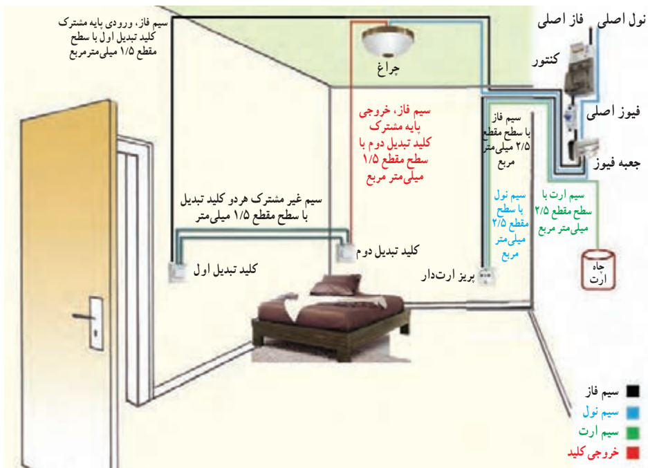
شکل ۱۸-۶ - سیم‌کشی مدار کلید تبدیل
