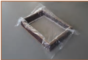
پ - قراردادن نایلون در قالب شکل ۲۰-۸ - تهیه قالب
