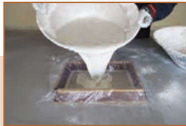
ث - ریختن ملات گچ در قالب
