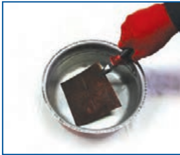
شکل ۹-۱۱- سرد کردن پلاک مسی با آب
